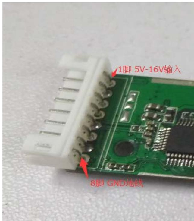
图2 电源/串口/视频输入座子
